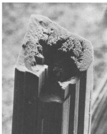
Abb. 15. Rasterelektronenmikroskopische Aufnahme eines W_5Nb_{16}O_{55} -Kristalls mit röhrenartigen Hohlräumen in Wachstumsrichtung. Durchmesser des nadelförmigen Kristalls etwa 0.1 mm.
